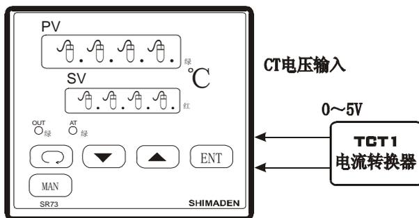
Y 和 P 型输出的加热器断线报警：
